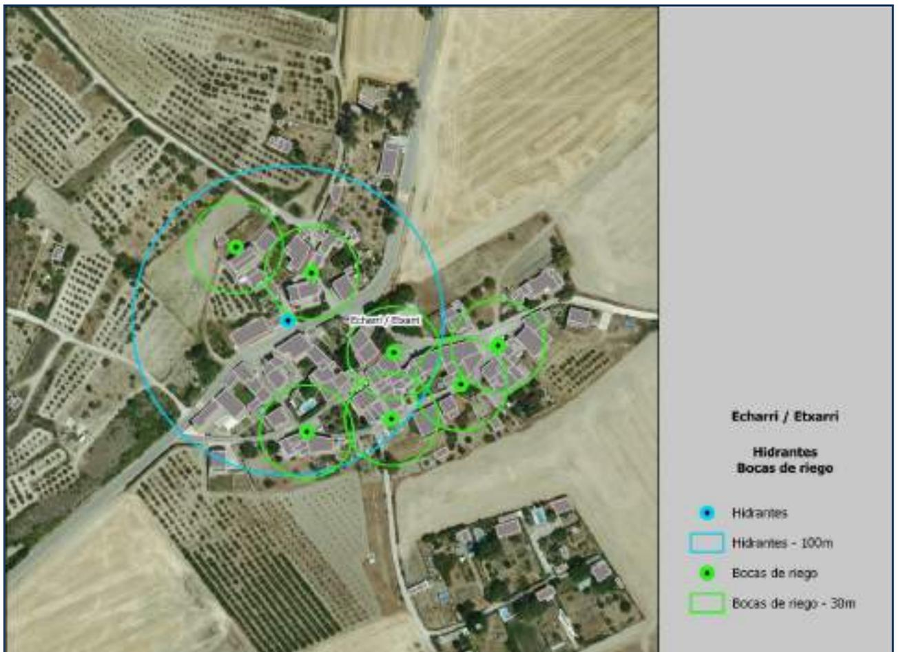
Ilustración 44. Hidrantes y bocas de riego.
